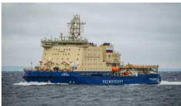
Дизель-электрический ледокол «Виктор Черномырдин» Мощность 25000 кВт
